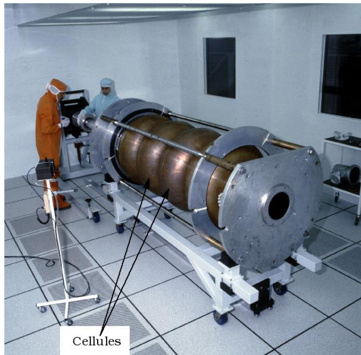
Fig. II.1 – Photo 1 : Pulvérisation de Niobium dans une cavité supraconductrice. Image issue du site CERN Document Server. ©CERN.
