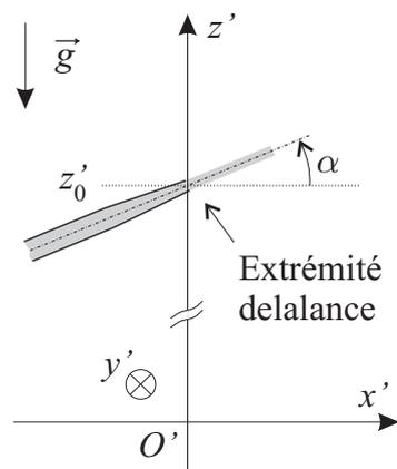
FIG. 3 – Configuration de l'extrémité de la lance.
