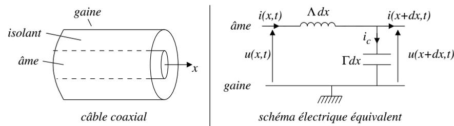
→ Le câble coaxial est constitué d'un cylindre intérieur et d'une gaine extérieure. Les deux parties, toutes deux en cuivre, conduisent le courant et sont séparées par un isolant électrique.
